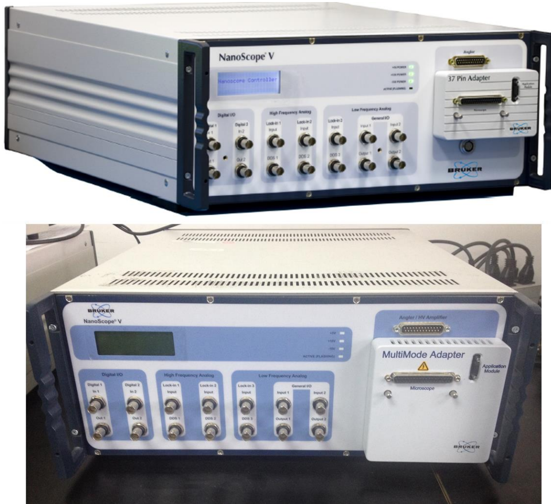
图 1-8 MultiMode8 SPM Nanoscope V 控制器。
